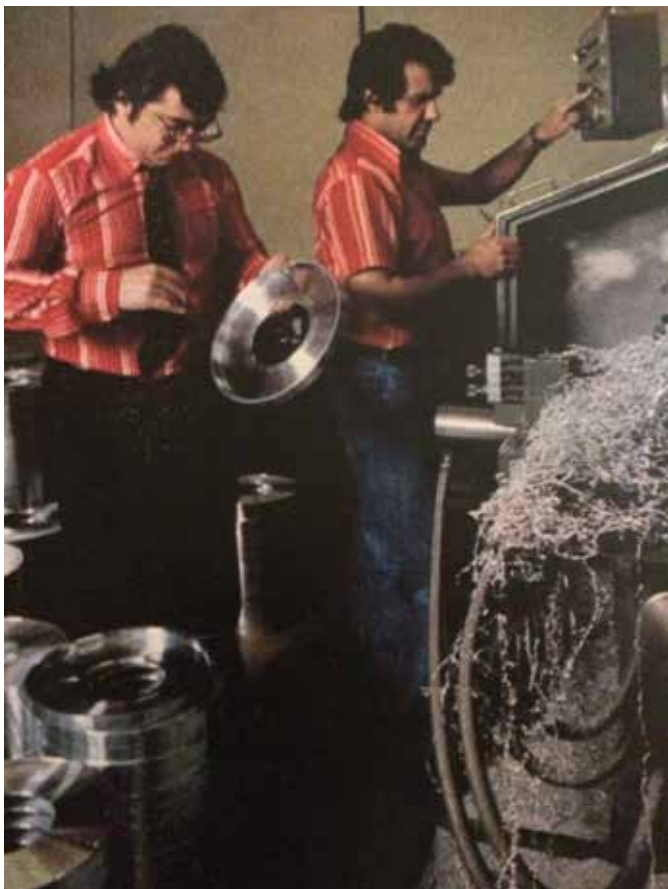
Realizzazione del piatto ottenuto da una fusione per gravità in stampo caldo in Linn. A reggerne uno il patron dell'azienda IvorTiefembrun in persona, allora giovanissimo.
